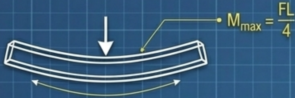
คาน (Beam) รับน้ำหนักทำให้เกิดการ ดัด (Flexural)
