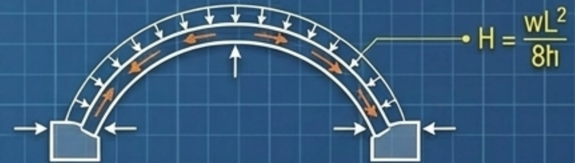
ส่วนโค้ง (Arches) โครงสร้างอยู่ได้ด้วยน้ำหนักกดกับตัวเอง เกิดแรงอัดขึ้นอย่างสม่ำเสมอ
