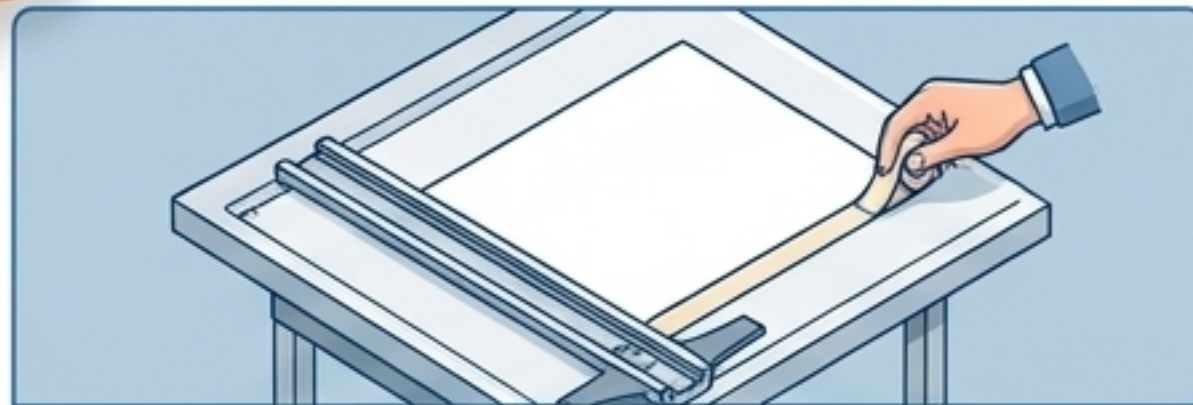
Step 3: ติดเทปกาวมุมที่ 3 (ขนานด้านล่าง)
