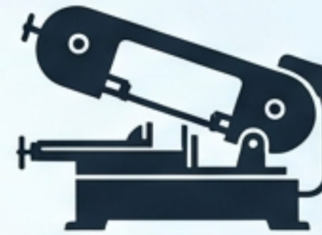
2. เครื่องเลื่อยกลสายพานแนวนอน (Horizontal Band Saw)
