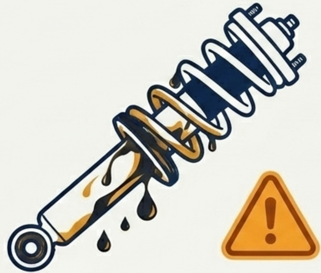
ใช้คอปป์รั่วซึม (Leaking Shock Absorber)
