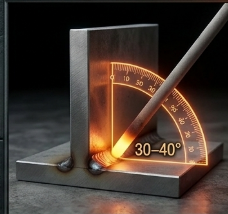
รอยต่อรูปตัวที (T-Joint)
