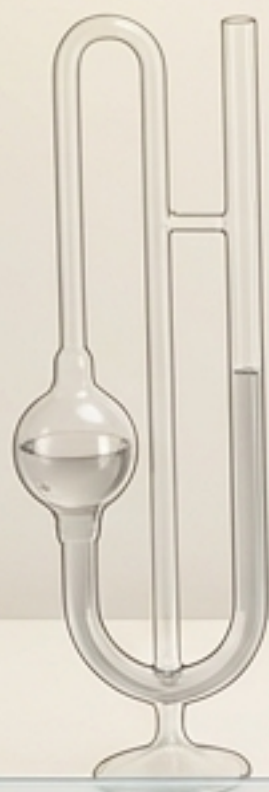
1. หลอดคาปิลลารี (Capillary Viscometer): วัดจากเวลาที่ของเหลวไหลผ่านหลอดรูเล็กด้วยแรงโน้มถ่วง
