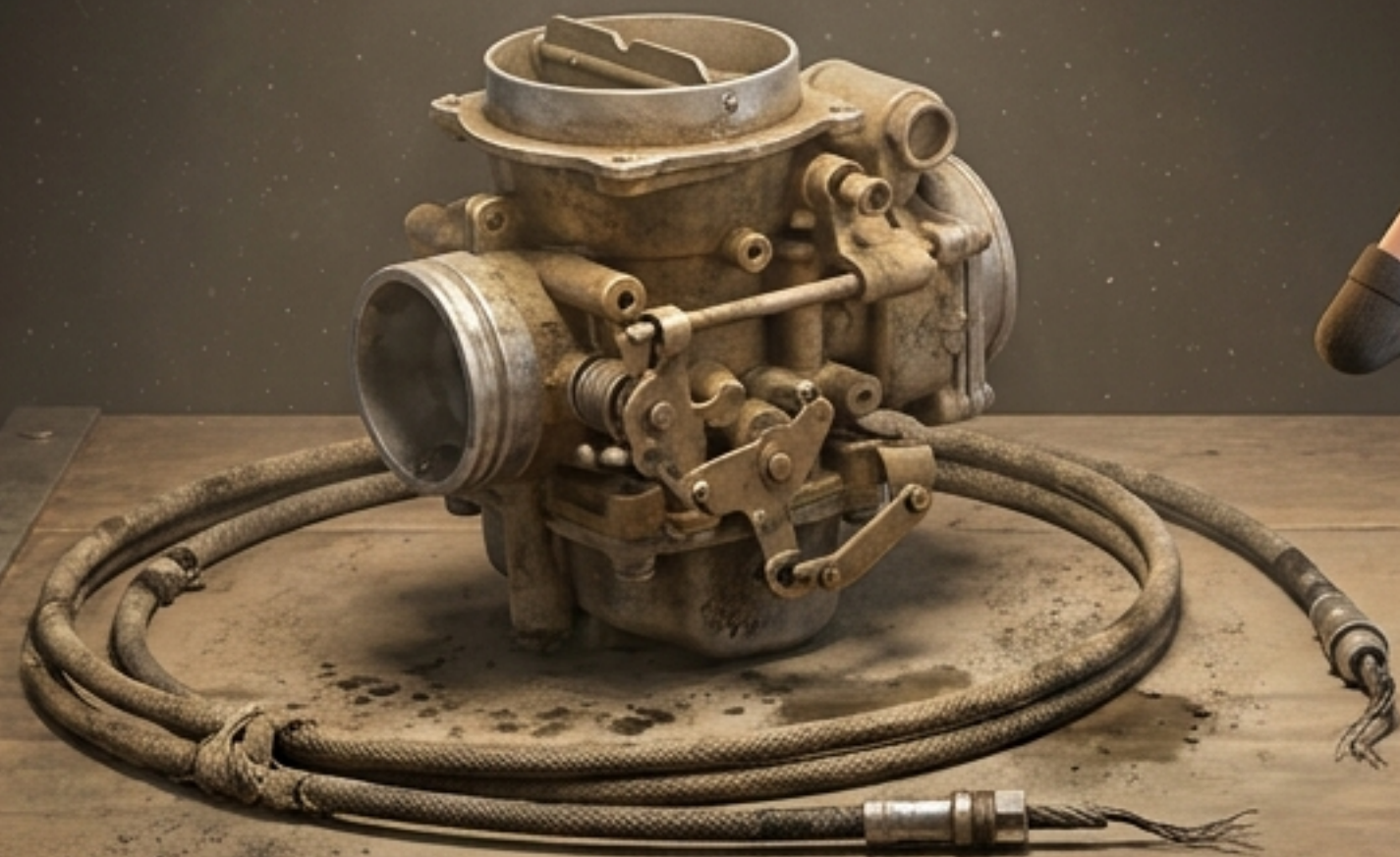
ระบบเดิม (คาร์บูเรเตอร์) จ่ายน้ำมันด้วยแรงดูดอากาศเชิงกล
